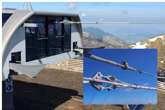
Double Dead-End Loop / Doppelabspannschleife
