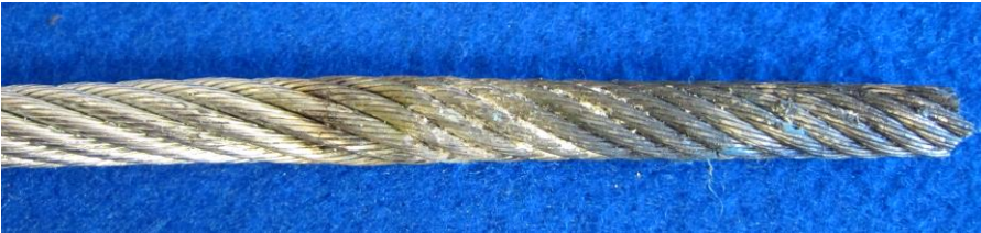
Seilende mit Schweissbrenner ausgeglüht und verdreht
