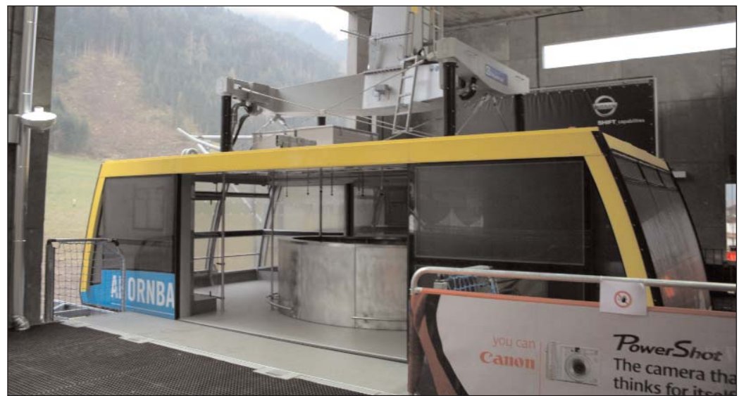
Mit den Maßen 9,0 x 4,6 m vermitteln die CARVATECH-Kabinen ein völlig neues Seilbahnkabinen-Raumgefühl
