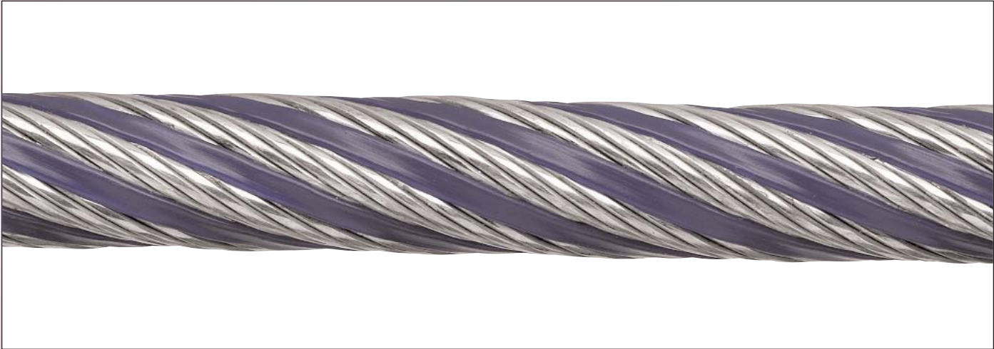
PERFORMA-Zugseil mit Kunststoff-Füllprofilen: Die neue Hungerburg-Standseilbahn in Innsbruck wird, als zweite Bahn nach der Dorfbahn in Serfaus, damit ausgerüstet. Die zylindrische Kontur des Litzenseiles sorgt für einen vibrationsfreien und damit lärmfreien Lauf
